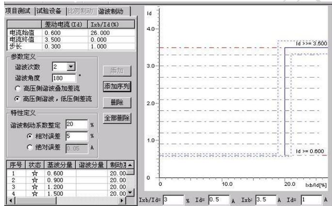
设置好谐波制动系数，结合前页的差动电流值和差动速断电流值，即可画出理论谐波制动特性曲线。
