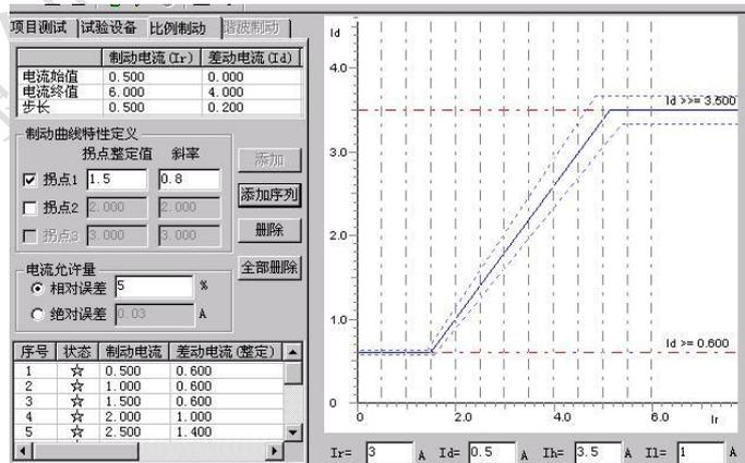
设置好搜索范围后，选“添加序列”或“添加”将搜索线数据填入测试数据列表中。选“开始试验”即可进行测试。选“删除”或“全部输出”可以删除所选择的单条或全部搜索线。
