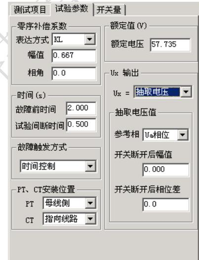
了做重合闸的检同期和检无压试验。
