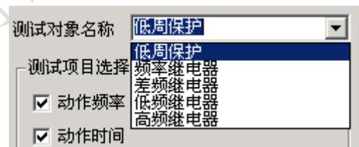
测试对象名称中包含“低周保护”、“频率继电器”、“差频继电器”、“低频继电器”以及“高频继电器”五种继电器。默认情况下选择“低周保护”。其下拉菜单如图所示：
