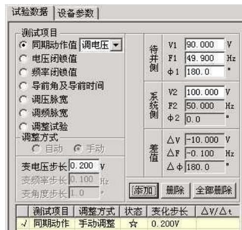
所设置的变化步长手动增减相应的量至同期接点动作，即测出相应的同期动作值。用该功能也可对线路检同期或检无压的重合闸保护进行测试。
