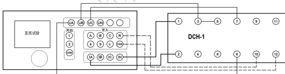
注意：若重合闸能充电但不能动作，请检查保持电流是否有输出。在充电期间，电流输出回路是断开的，所以测试仪的电流输出开路指示灯亮。当重合闸动作时，测试仪的电
