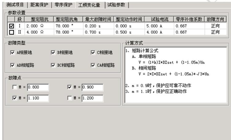
M 的值默认情况下有 0.9 和 1.1 两种设置，一般地，M=0.9 时，保护应可靠不动作，M=1.1 时，保护应可靠动作。设置 M=1.2 时，可以测出保护的動作时间。
