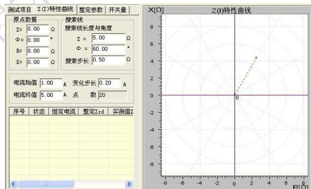
本试验的方法过程很像做差动继电器试验。如果把这里的阻抗比做差动试验的“制动电流”，则这里的电流就相当于“动作电流”。试验时，阻抗初始值为 0，按一定的搜索步长
