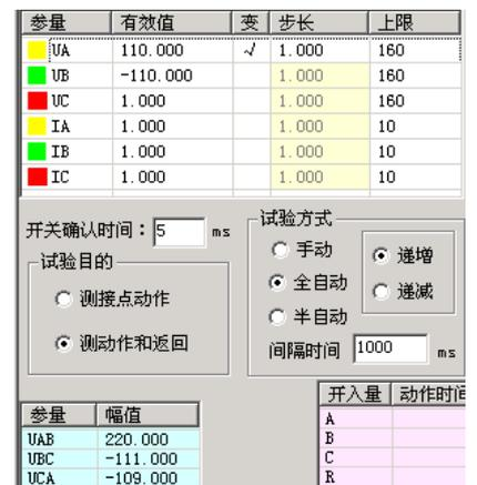
320V。比如  $U_A=100V$ ， $U_B=-100V$ ，则  $U_{AB}=100-(-100)=200V$ ，右图所示。线电压的幅值显示在主界面的左下角。 $U_A$  和  $U_B$  的值不一定要求相等，但需注意正、负极性。
