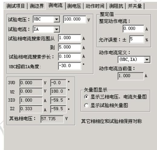
试验时，选取一个线电压，为非变量；选取第三相电流，为变量。电流的变化范围应包含保护的整定动作电流。软件对角度的定义是：电压超前电流的角度为正。所以设置角度时应注意正、负角。一般，当角度为最大灵敏角或接近最大灵敏角时，保护动作最灵敏，测出的动作电流也趋于一个定值。当设置的角度接近两个动作边界或稍微超出边界，测出的动作电流可能偏大或不动作。
